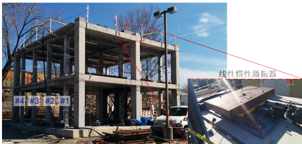
图: 钢筋混凝土框架结构模型
